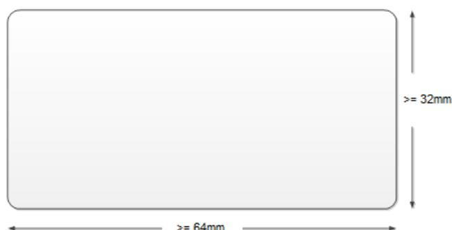
Les meilleurs appareils Windows Precision Touchpad doivent avoir les dimensions recommandées d'environ 65mm x 105mm, comme indiqué dans le diagramme suivant, pour permettre des interactions plus confortables.
