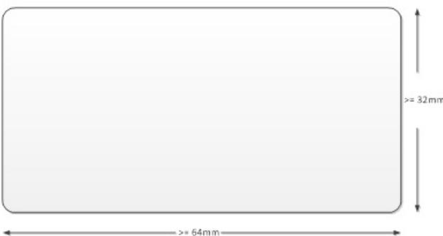
Figure 3 taille minimale du pavé tactile de précision
