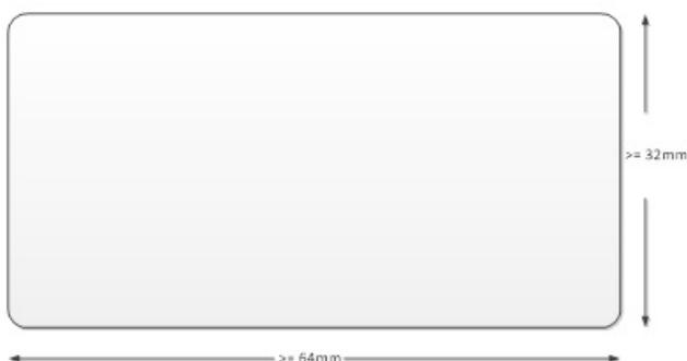
Figure 1 taille minimale du touchpad Windows Precision
