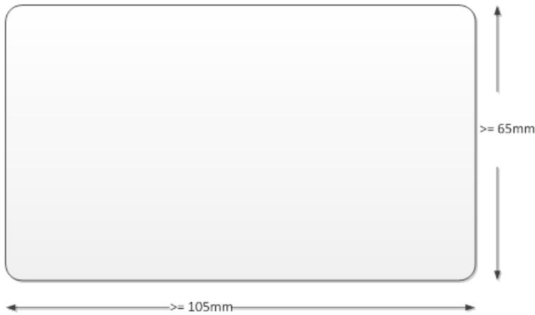
Figure 2 taille optimale du pavé tactile de précision
