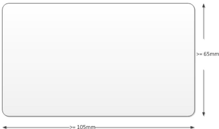
Figure 2 taille optimale du touchpad Windows Precision
